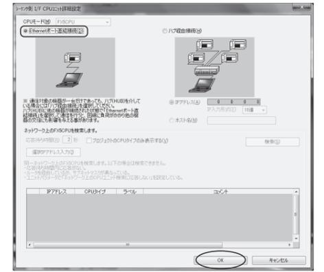
3. 「通信テスト」をクリックし MELSEC-FX5CPU との接続を確認した後、「接続先指定」の「OK」をクリックすると接続先指定が完了します。
