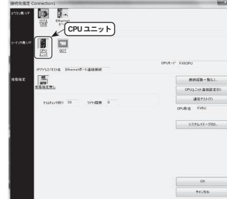
2. 「Ethernet ポート直結接続 (D)」を選択し「OK」をクリックしてください。
