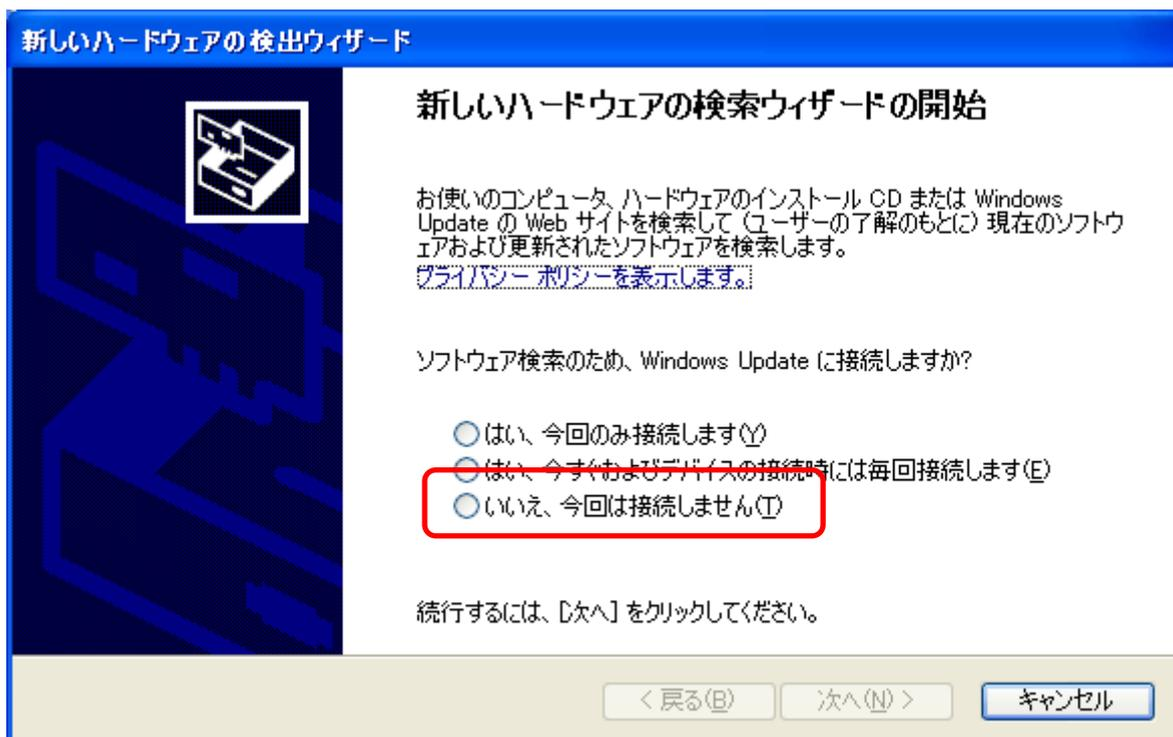
ドライバインストーラ実行中に「新しいハードウェアの検索ウィザードの開始」画面が表示された場合、「いいえ、今回は接続しません」を選択し、「次へ」をクリックするとドライバインストーラはそのまま続行されます。
