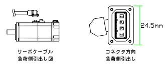
※許容曲げ半径:ケーブル外径の10倍以上
