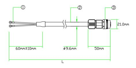
※圧着端子側にマークチューブ付属 ※許容曲げ半径:ケーブル外径の6倍以上
