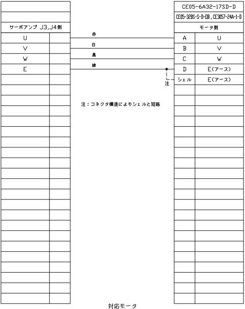
対応モニタ J4用: HG-JR11K1M(B), HG-JR15K1M(B) J3用: HF-JP11K1M(B), HF-JP15K1M(B)
