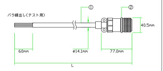
※マークチューブ付属 ※許容曲げ半径:ケーブル外径の6倍以上 ※三菱コネクタMR-PWCNS5相当品使用
